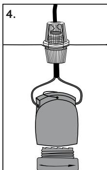
Bij gebruik van een opspanklem moet men zorgen dat de lamp stevig vast zit. De lamp mag niet aan buizen bevestigd worden.
