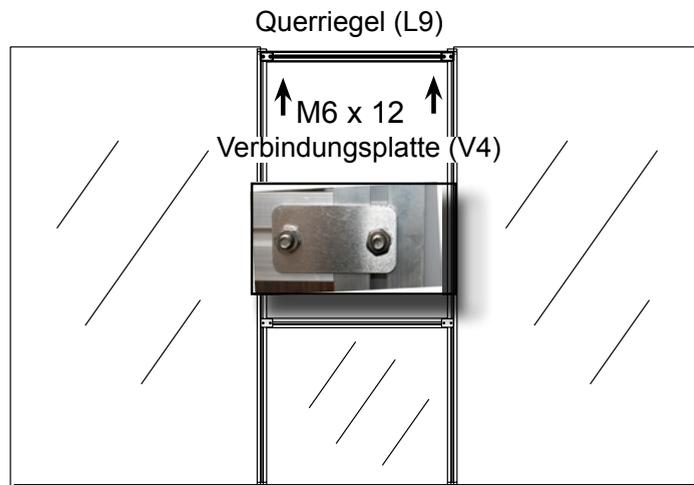
Auch im oberen Bereich wird der Querriegel mittels Verbindungsplatte (V4) und Sechskantschrauben M6 x 12 (S12) fixiert.
