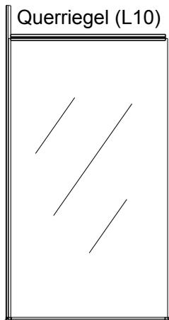
Setzen Sie die Querriegel (L10) auf die Verglasung.
