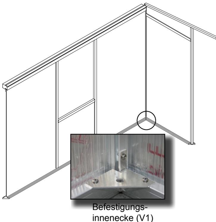
Mit der Befestigungsinnenecke (V1) werden die beiden Elemente miteinander verschraubt.
