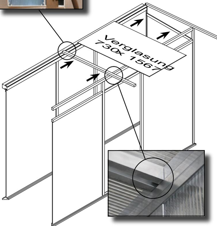
Fädeln Sie nun die Dachverglasung ein, d. h. sie wird in die Nut des Randprofils eingeschoben.
