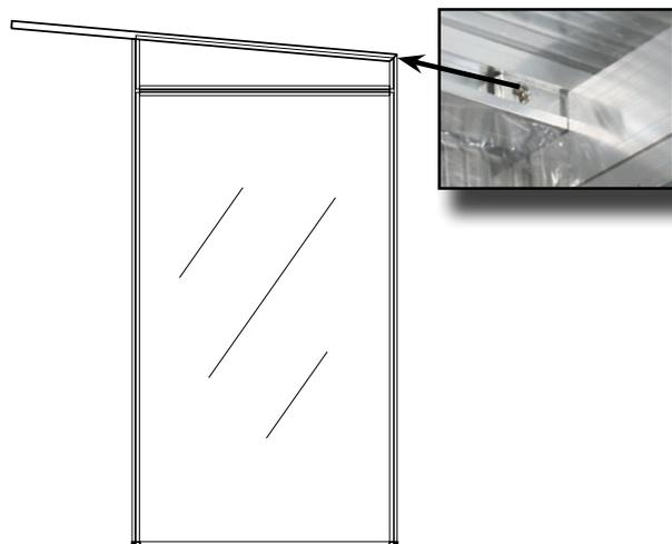
In die Nut der Randsprosse wird der Winkel mit Madenschraube eingeschoben.
