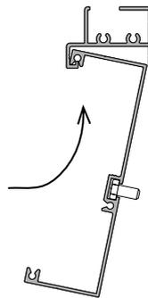
Zunächst schieben Sie bitte die Mittelsprossen bis zu den Bohrungen des Bodenprofils ein.
