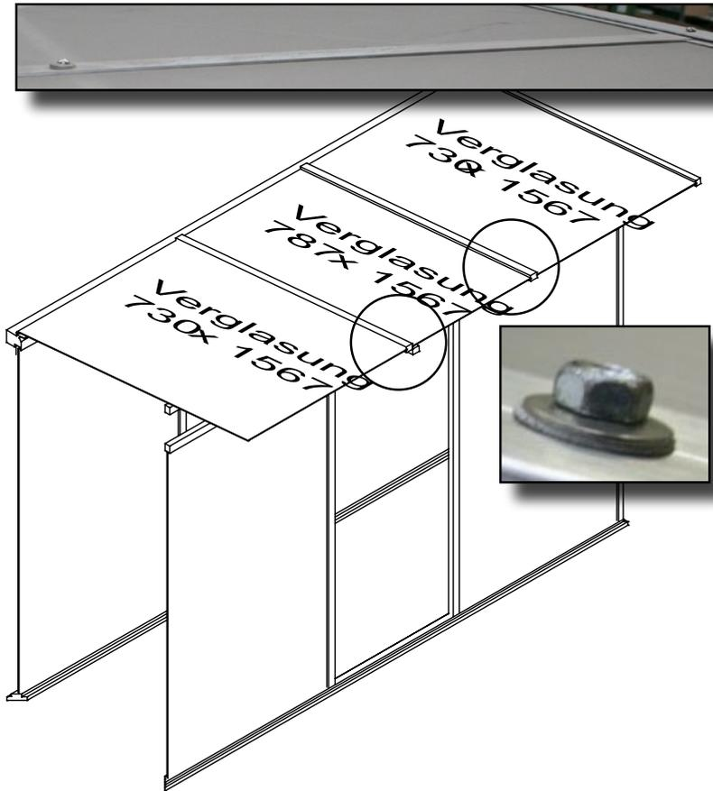
Diesen Vorgang, wie in Schritt 23 beschrieben, wiederholen Sie, bis das Dach vollständig verglast ist.
