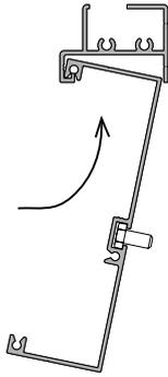
Die Fundamentrahmenprofile einzeln in die Bodenprofile drehen und mittig ausrichten.
