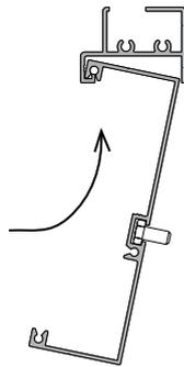
Die Eckverbinder (V9) werden auf das Bodenprofil (L2) gesteckt.
