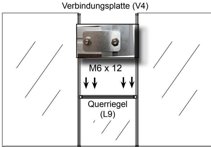
In den Querriegel (L9) werden vier Sechskantschrauben M6 x 12 (S12) eingeschoben. Anschließend wird dieser auf die Verglasung gesteckt.
