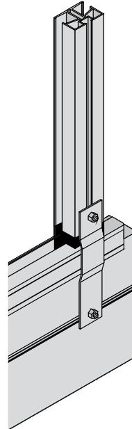
Zur Stabilisierung des Fundamentrahmens am Bodenprofil werden die Befestigungslaschen (V27) mittels eingezogener Schrauben M6 x 12 (S12) am Fundamentrahmen und an den Mittelsprossen verschraubt.
