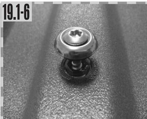
... und mit demselben Torx 20-Bit einschrauben...
