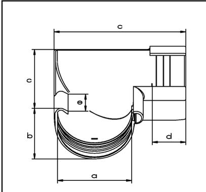
Mit der Innenecke werden (über das Nocke-Nut-System) zwei Dachrinnenenden verbunden. Bei der Montage ist die Einstecktiefe 'd' zu beachten (siehe Montage -Anleitung).
