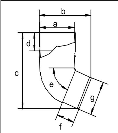
Mit Hilfe des Bogens 67° sind Verbindungen zwischen Fallrohr und Stützen oder zwischen zwei Fallrohren möglich. Zur Verbindung von zwei Bögen muss ein Fallrohrstück oder der Bogenverbinder zwischengesetzt werden.
