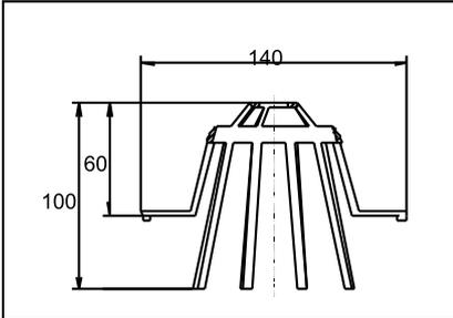
Der Laubfangkorb wird in den Stutzen der halbrunden Dachrinne eingesetzt und verhindert so eine Verstopfung des Fallrohres.
