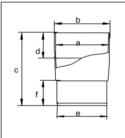
Mit Hilfe der Rohrmuffe sind Verbindungen zwischen Fallrohr und Stützen oder zwischen zwei Fallrohren möglich.
