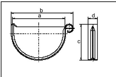
Mit einem Endstück lässt sich das Ende einer Dachrinne durch eine Steckverbindung verschließen. Endstücke sind nicht verwendbar bei Stutzen, Eckstücken oder der Rinnenverbindungsschale
