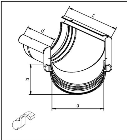
Die Sonderecke 135° kann als Innen- oder Außenecke gleichermaßen verwendet werden. Bei der Montage ist die Einstecktiefe zu beachten (siehe Montage-Anleitung). Werkseitig erfolgt die Auslieferung als Außenecke. Bei der Verwendung als Innenecke muss der Clip umgesteckt werden.
