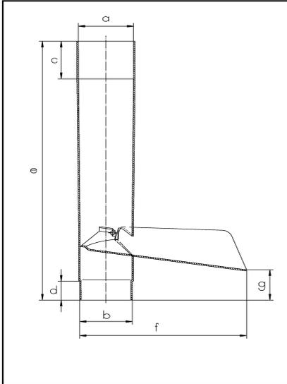
Die Wasserablaufklappe wird ohne Zusatzeile in ein Fallrohr eingebaut. Bei nachträglicher Montage ist in der gewünschten Höhe ein entsprechend langes Fallrohr -Segment herauszuschneiden. Durch Schwenken der Klappe (nach oben oder unten) wird das Regenwasser in die Kanalisation oder z.B. eine Tonne geleitet.
