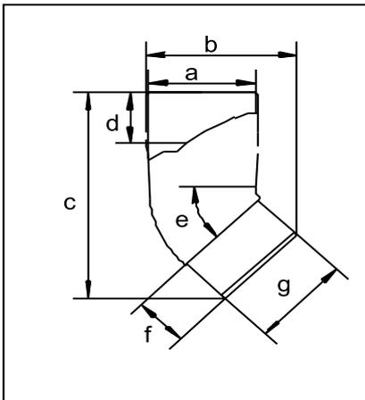
Mit Hilfe des Bogens 45° sind Verbindungen zwischen Fallrohr und Stützen oder zwischen zwei Fallrohren möglich. Zur Verbindung von zwei Bögen muss ein Fallrohrstück oder der Bogenverbinder zwischengesetzt werden.
