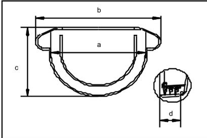
Mit einem Endstück lässt sich das Ende einer Dachrinne durch eine Steckverbindung verschließen. Endstücke sind nicht verwendbar bei Stützen, Eckstücken oder der Rinnen Verbindungsschale
