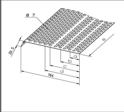
Laubfrei schützt die Dachrinne vor Laub und Verschmutzung. Bei der glatten Abdeckung der Dachrinne kann sich kein Laub festsetzen. Die Montage erfolgt mit den mitgelieferten Kunststoffklammern an der Wulst der Dachrinne. Laubfrei kann an allen Dachrinnensystemen mit einer Wulst montiert werden. Die Markierungen auf der Unterseite dienen als Hilfe für den Zuschnitt bei kleineren Dachrinnen.
