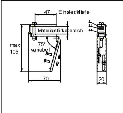
Zum Befestigen der Dachrinne RG 100 mit dem Rinnenhalter aus Kunststoff an Welle 8-130/3 und Profil 76/18 (kleingewellt) und an Stegdo ppelplatten. Klemm-Möglichkeit für drei Materialstärkebereiche:
