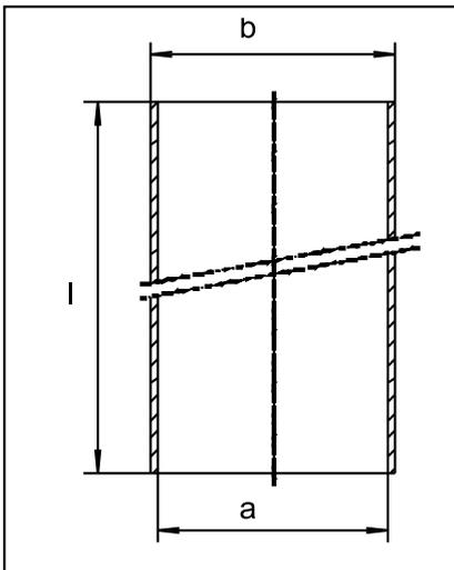
Fallrohre müssen mit einer separaten Rohrmuffe verbunden werden. Befestigung der Fallrohre mit Rohrschellen im Abstand von ca. 2m. Unter der Verbindung immer eine Fest-Schelle setzen.
