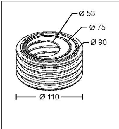
Gummimanschette für Fallrohranschlüsse an die Grundleitung (KG-Rohre DN 110). Mit der Gummimanschette können Fallrohre DN 53, DN 75, DN 90 an eine KG-Muffe oder an das KG-Spitzenende angeschlossen werden. Der Zuschnitt der erforderlichen Nennweite erfolgt mit einem Cuttermes ser.
