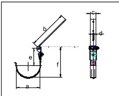
Das verstellbare Rinneneisen ist im sichtbaren Bereich in der Rinnenfarbe lieferbar. Montiert werden die Rinneneisen in einem Abstand zwischen 50 und 70 cm. Das Gefälle und die Neigung der Dachrinne ist nach der Montage einstellbar (s. Montage-Anleitung).
