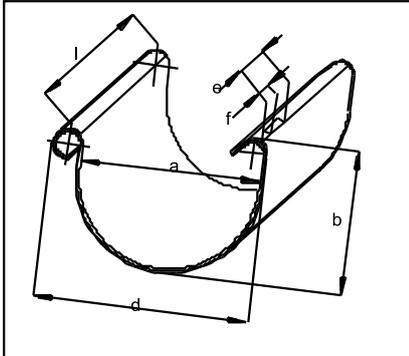
Das Nocke -Nut-System bei Dachrinne und Rinnenverbindungsschale sowie bei Dachrinne und den Ecken verhindert ein Verbeulen und Auseinanderrutschen bei Temperaturschwankungen. .
