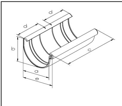
Mit der Rinnenverbindungsschale lassen sich zwei halbrunde Dachrinnen verbinden (Nocke -Nut-System). Bei der Montage ist die Einstecktiefe 'd' zu beachten (Siehe Montage -Anleitung).
