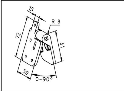
Der neue Verstellwinkel ist speziell für die Montage von den halbrunden Dachrinnen RG 100 und RG 125, an Block- oder Gartenhäusern mit rechtwinklig zur Dachneigung angebrachten Stirnbrettern, gedacht. Der Kunde kann so die gewünschte Halbrunddachrinne von Marley einfach und schnell an sein Blockhaus montieren kann.
