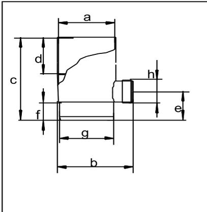
Mit Hilfe der Anreißschablone wird der Ausschnitt am Regenfallrohr angezeichnet und herausgesägt. Der Regensammler wird mit Dichtungen in das Fallrohr eingebaut (siehe beiliegende Montage -Anleitung).
