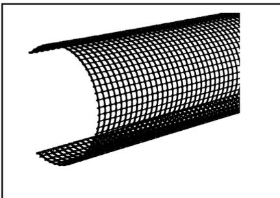
Poly-Net-Laubstop kann mit einer kräftigen Schere zugeschnitten werden. Er wird nach oben gewölbt eingebaut und klemmt durch seine Eigenspannung in der Dachrinne fest. Poly-Net-Laubstop kann für alle Dachrinnenformen verwendet werden. Die Breite der Größe 100 -125 beträgt 295 mm und bei der Größe 150 -180 ist es 450mm breit. Die Maschengröße ist 6x6mm.
