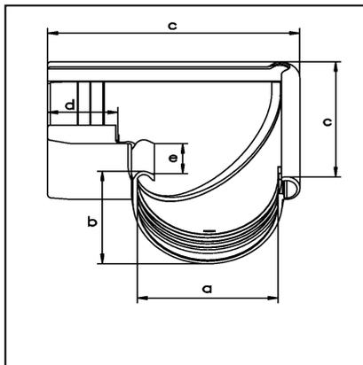
Mit der Außenecke werden (über das Nocke -Nut-System) zwei Dachrinnenenden verbunden. Bei der Montage ist die Einstecktiefe 'd' zu beachten (siehe Montage -Anleitung).
