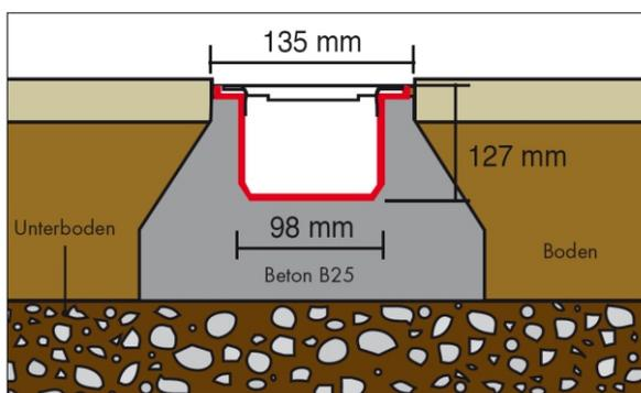
Einfache und schnelle Verlegung in Beton
